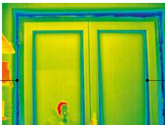
Akna termograafiline kujutis
